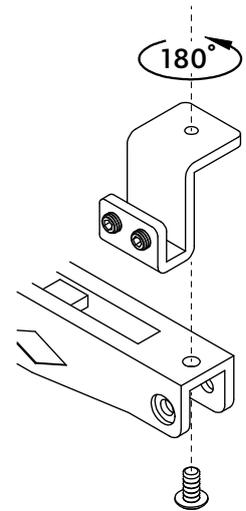
**NL** - Verwijder de eventueel aanwezige deurstopper. Plaats de softcloser aan de linker- of rechterzijde van de rail, voor de laatste steun (1), en fixeer met de 4 meegeleverde inbusboutjes (2). Plaats vervolgens de deurstopper aan het uiteinde van de rail (3). Deze dient nu als veiligheidsstop.
